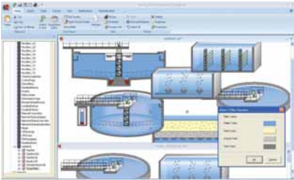
Рис. 15. Некоторые из специализированных объектов Динамо для водоснабжения/водоотведения из библиотеки iFIX Water Solution Pack
